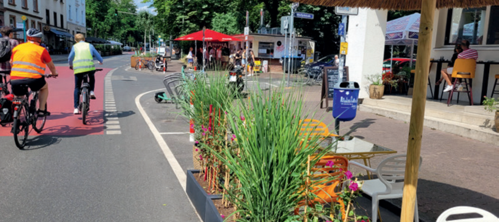
Bild 12: Beispiel für eine temporäre Umnutzung von Kfz-Parkständen für die Außengastronomie (Foto: ©Thiemo Graf/Innovative Städte)
