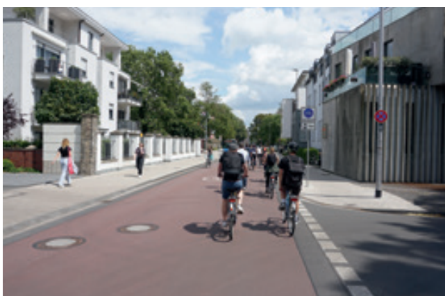
Bild 9: Fahrradstraßen mit flächiger Roteinfärbung innerhalb eines bebauten Gebiets (links) und außerhalb mit Fahrbahnrandmarkierung (rechts). (Fotos: ©Thiemo Graf/Innovative Städte)
