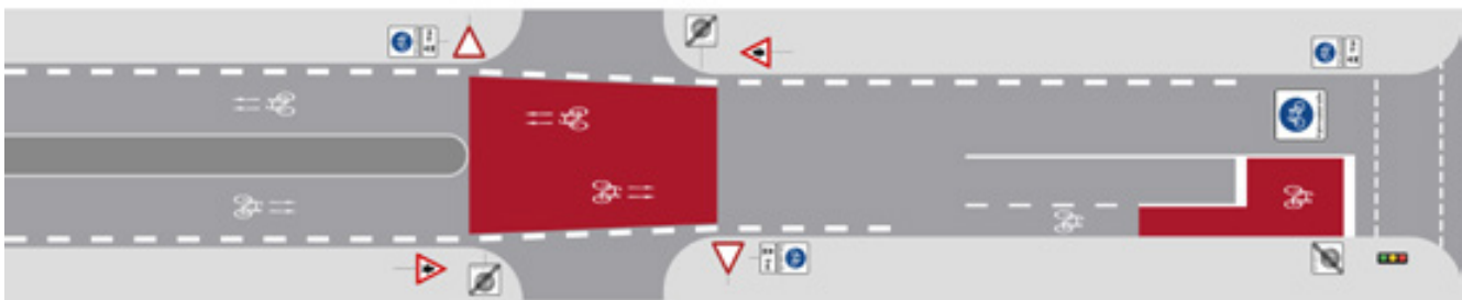
Bild 26: Beispiel für die Umgestaltung einer Erschließungsstraße zur Fahrradstraße mit einer breiten Fahrgasse mit Mitteltrennung (Grafik: ©Innovative Städte)
