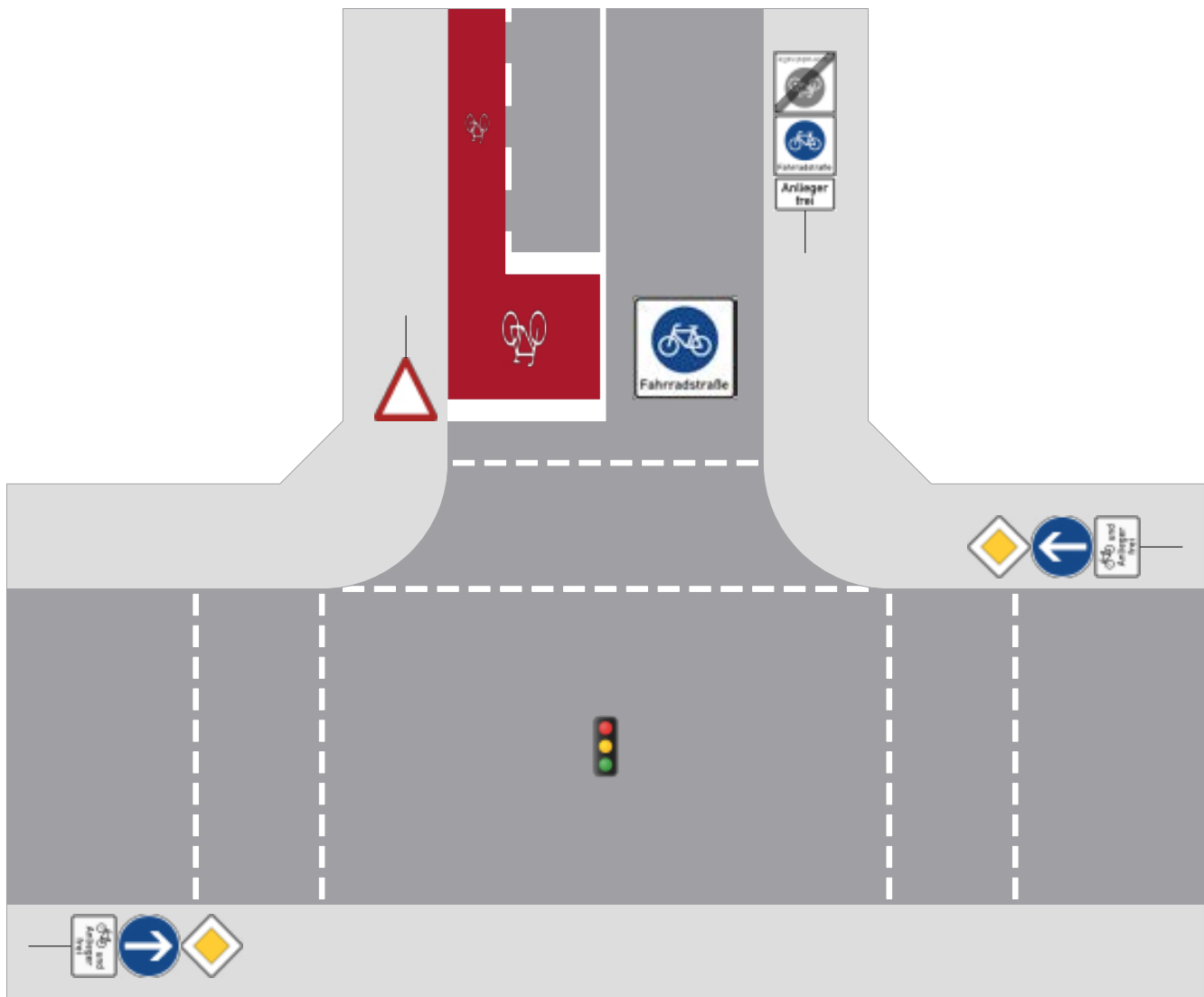
Bild 21: Am Ende einer Fahrradstraße kann dem Radverkehr mit einem Schutzstreifen und einem erweiterten Radaufstellstreifen das Vorbeifahren an sowie das Aufstellen vor wartenden Kraftfahrzeugen ermöglicht werden. (Grafik: ©Innovative Städte)
